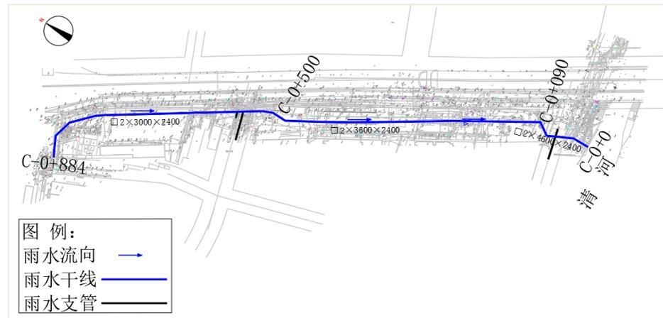
图 1.1-3 C 段雨水干线及支管路线示意图
