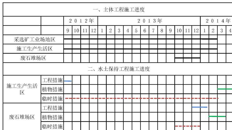
图 3.3-1 项目水土保持措施实施进度横道图
