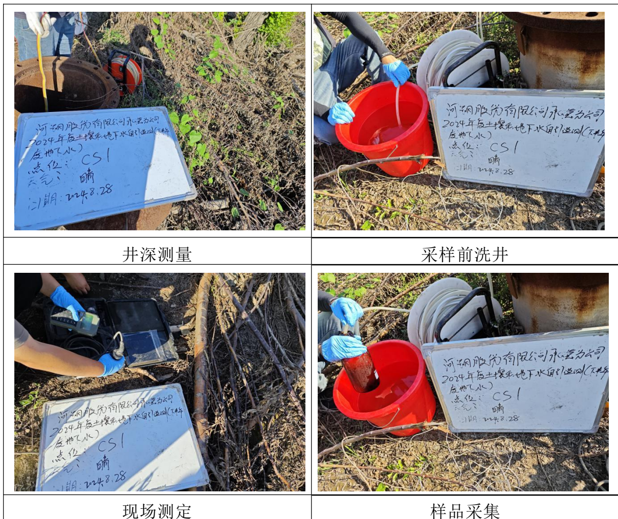
图 7-6 地下水采样前洗井及样品采集照片
