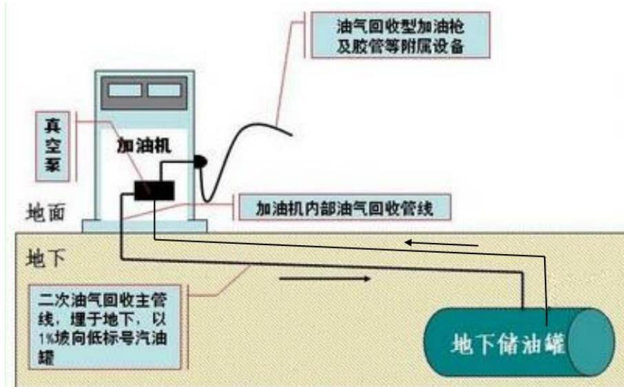
图 2-3 加油过程中油气回收原理示意图
