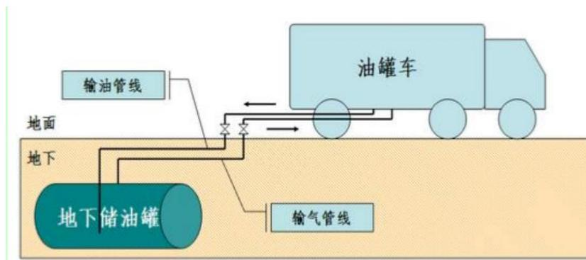
图 2-2 卸油过程中油气回收原理示意图
