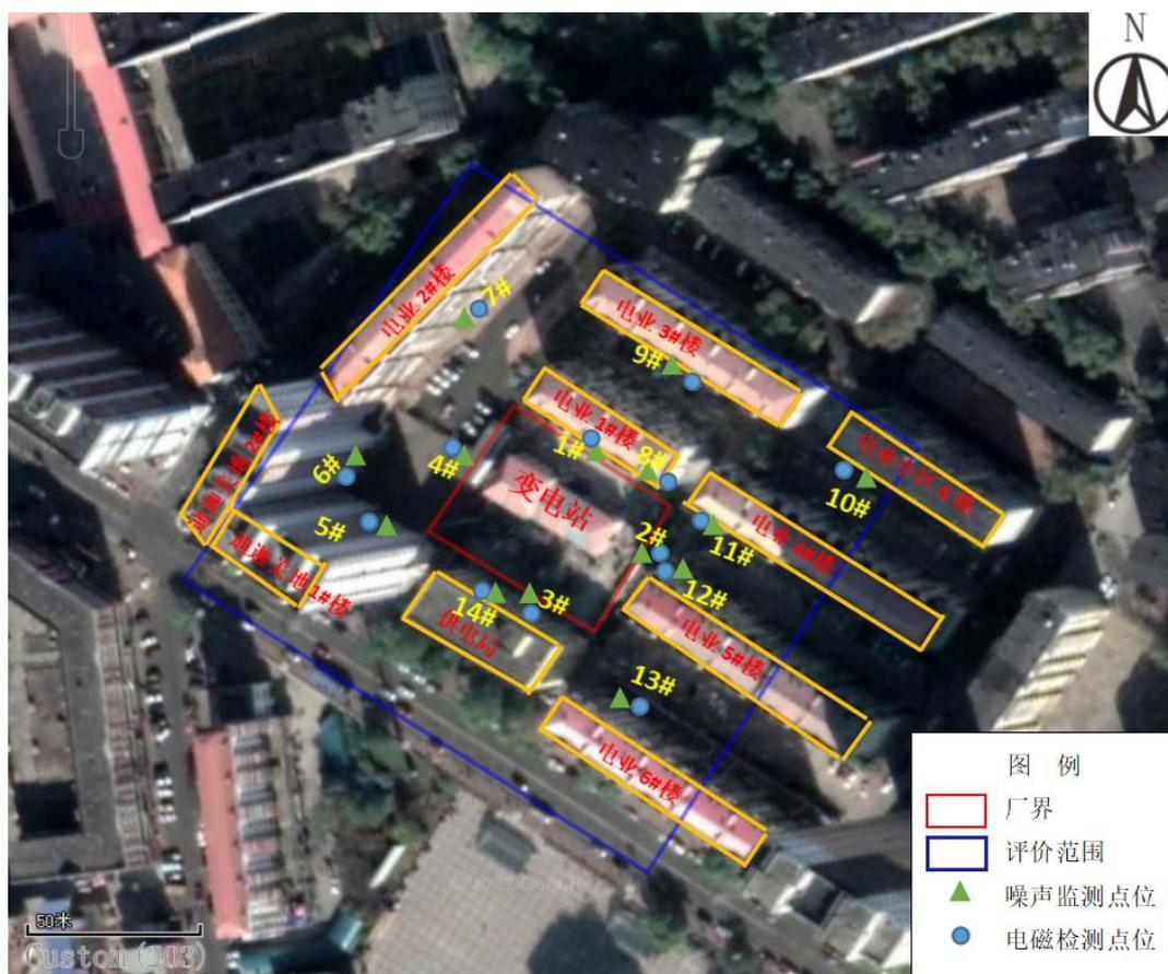
图 7-1 发电 110 千伏变电站监测布点示意图
