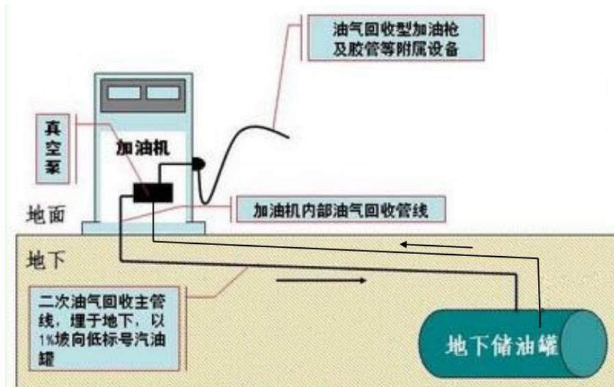
图 2-3 加油过程中油气回收原理示意图
