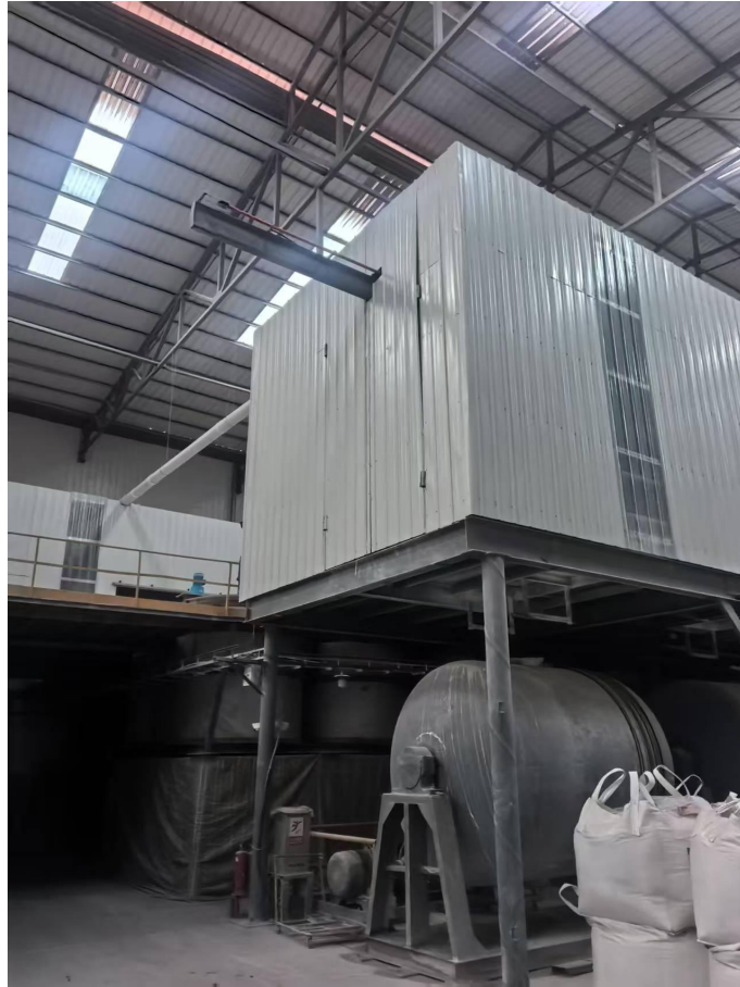
坯底粉球磨机上方设置集气罩
