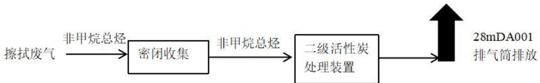
图 4-1 废气处理流程图
