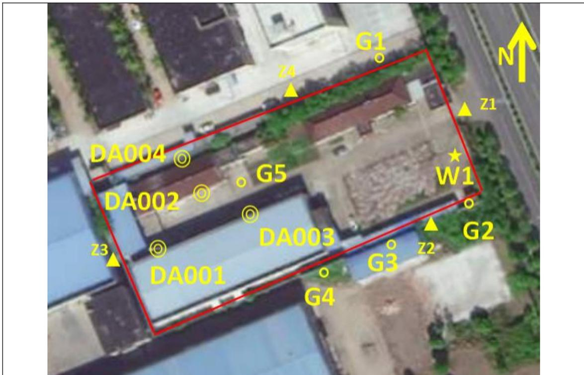
图9.2-3 噪声监测点位图（厂界噪声Z1~Z4）
