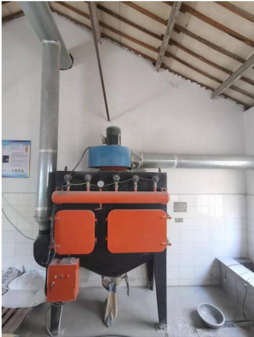
投料、磨粉废气处理设施“袋式除尘装置”
